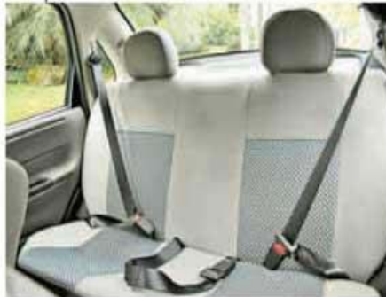
...JÁ NESTE, UM DOS CINTOS É SUBABDOMINAL E FALTA O TERCEIRO APOIO
