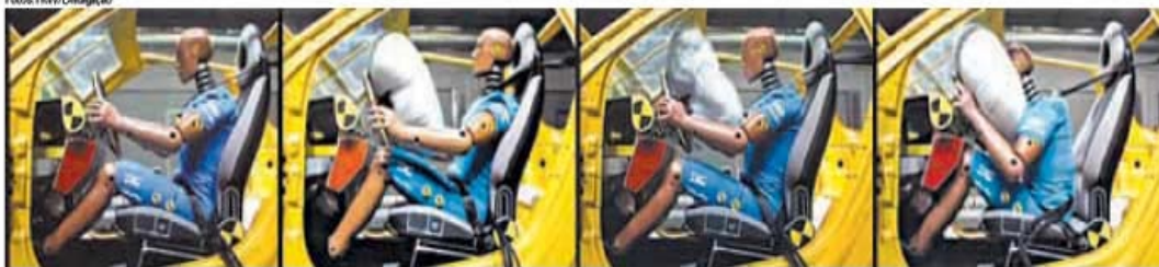
SIMULAÇÃO DA SEQUÊNCIA DE ABERTURA DO AIRBAG: EM ATÉ 20 MILISSEGUNDOS
