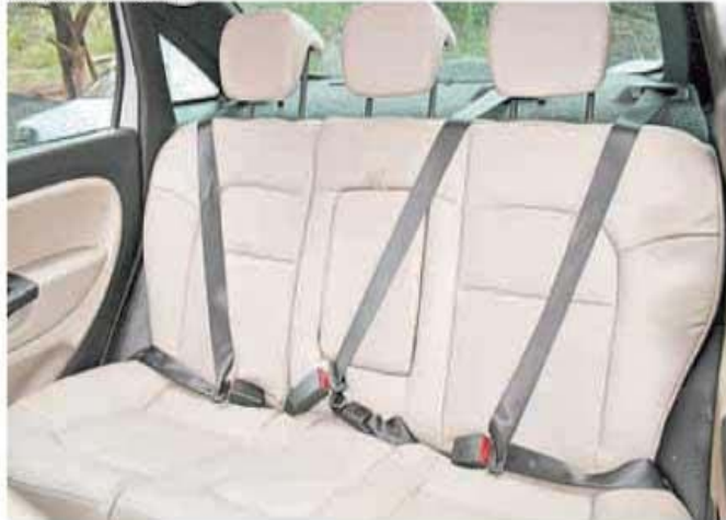
ACIMA, O VEÍCULO ESTÁ COM TODOS OS ITENS DE SEGURANÇA: TRÊS APOIOS DE CABEÇA E CINTOS DE TRÊS PONTOS
